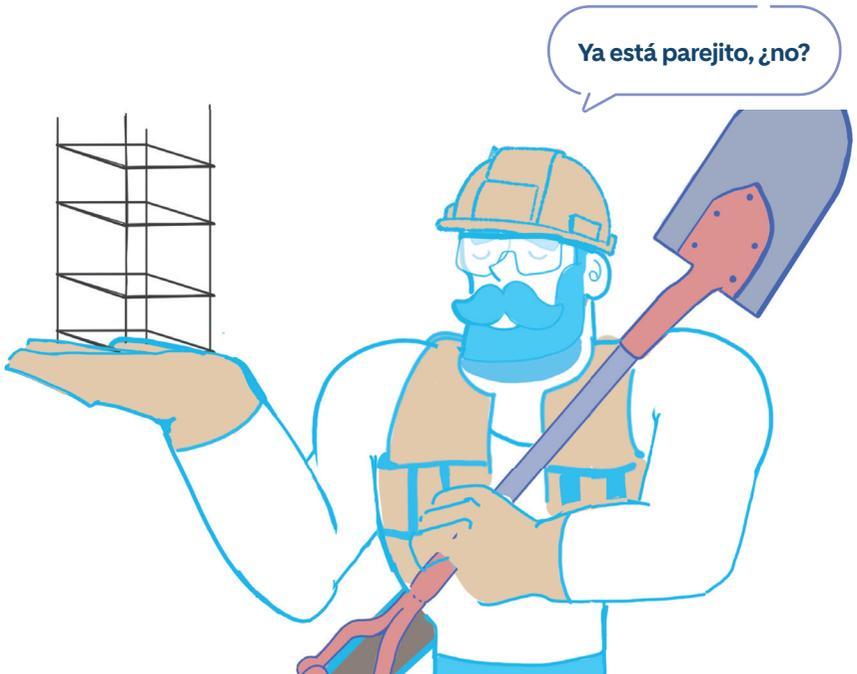
**TIP:** Para saber el nivel del piso terminado debemos conocer el espesor del material que se pondrá como recubrimiento sobre el firme de concreto: puede ser loseta de barro, loseta vinílica, madera, etc. Si no tendrá ningún recubrimiento, es recomendable que el nivel de piso terminado quede al menos un escalón arriba del nivel del terreno.
