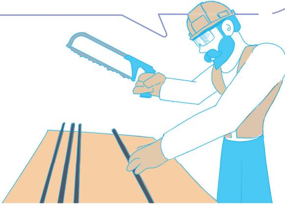
**TIP:** Además de la protección, como guantes anticorte y careta, si se utiliza una herramienta eléctrica de corte, verifica la calidad del disco y tener siempre un extintor al alcance.
