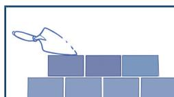
Podremos terminar de asentarlo golpeando la pieza con la cuchara, con la que retiraremos los excedentes laterales de material para colocarlos en las juntas verticales.
