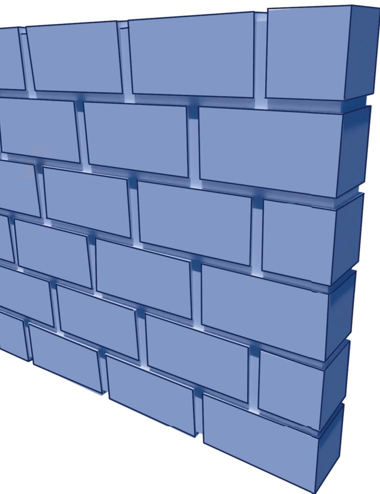
El muro al hilo, o de 12 cm de ancho, es el más común. Actualmente las dimensiones más comunes para la fabricación de tabicón son: 15 cm de espesor, 20 cm de ancho y 40 cm de largo.
