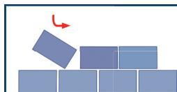
Para colocar la pieza es conveniente seguir un movimiento deslizante como indica el dibujo.
