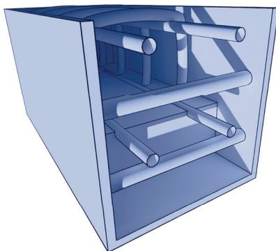
Las cadenas de remate o cerramiento se cuelan a medio peralte de la cimbra, dejando sin concreto las varillas superiores para amarrar las varillas de la losa.
